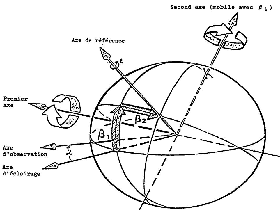
Système angulaire de la CIE pour la spécification et la mesure des rétroréflecteurs
